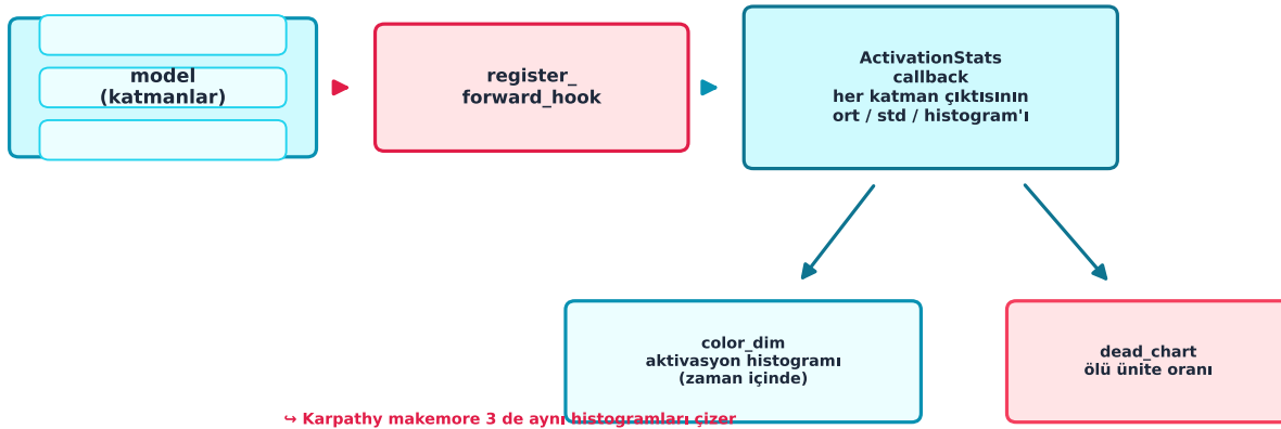
Şekil 26.2: (şematik: telemetri — register_forward_hook ile katman aktivasyon istatistiklerini izle ( ActivationStats callback); sorunu görmek çözmenin ilk adımı)
